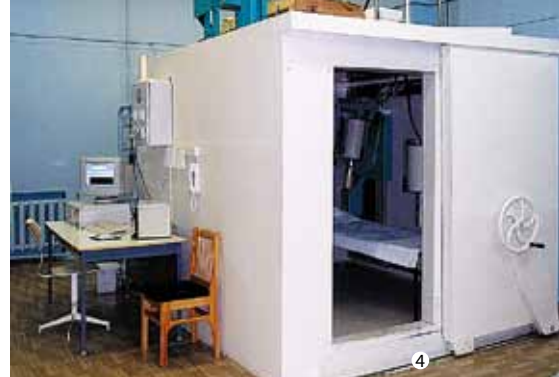
1, 2) Оборудование для определения уровней загрязнения мест ранений актиноидами, 3) \alpha -спектрометр, позволяющий повысить чувствительность и селективность измерений в биосубстратах персонала предприятий, 4) установка СИЧ, позволяющая проводить прямые измерения содержания трансураниевых радионуклидов в организме человека
