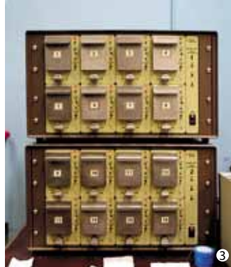
1, 2) Оборудование для определения уровней загрязнения мест ранений актиноидами, 3) \alpha -спектрометр, позволяющий повысить чувствительность и селективность измерений в биосубстратах персонала предприятий, 4) установка СИЧ, позволяющая проводить прямые измерения содержания трансураниевых радионуклидов в организме человека
